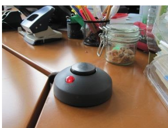
Bild 2: ECO-Button zur Vermeidung von Stand-by-Betrieb
